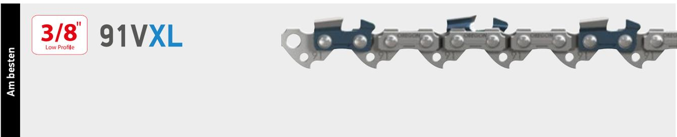
91VXL ist eine High-Performance, Low-Profile-Kette. Sie ist ideal für professionelle Baumpfleger und Obstbauern, die leichte Kettensägen verwenden. Die Schneidezähne sind 33% länger als die Standard 91 Schneider. Die wenig vibrierenden Halbmeißel-Zähne sorgen für einen sauberen Schnitt mit einem wenig anfälligen Schärfeprofil und guter Schnitthaltigkeit.
