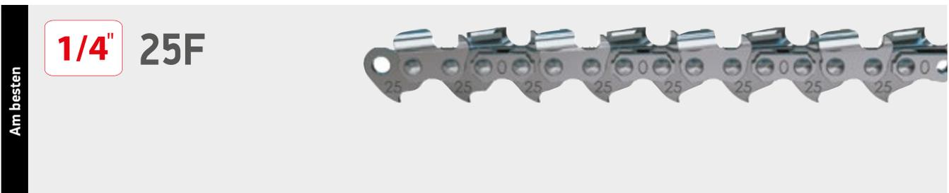
Für Anwender mit fürs Schnitzen konzipierten Schienen mit einer Spitze von 10 mm Radius oder weniger. Die Sequenz „Full House“ macht diese OREGON Sägekette 25F zur bevorzugten Kette von Schnitzern zum Sägen und Fräsen von feinen Einzelheiten und Ausbaurbeiten. Micro Chisel-Schneider haben einen kleinen Radius und kommen in die kleinsten Ecken, für hervorragende Leistung bei einfacher Wartung. Durch ihre geringe Größe und ihr leichtes Gewicht lässt sich die 25F mühelos handhaben.
