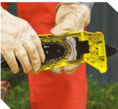
Wenn eine Kette durch normalen Gebrauch, stumpf wird, bringen Sie einfach den Schärfaufsatz an der PowerSharp®-Führungsschiene an. Die zwei Führungslöcher an der Spitze der Schiene stellen die perfekte Ausrichtung sicher.
